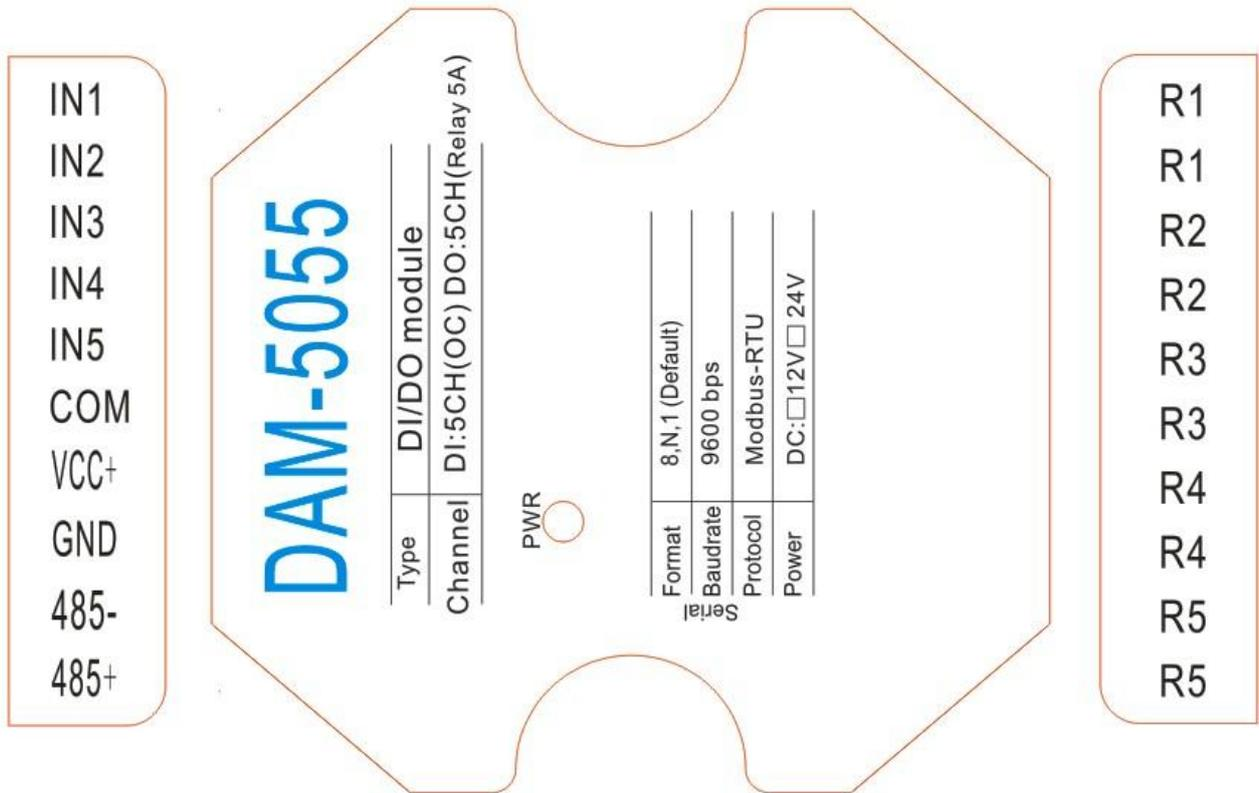
图 3-3 DAM-5055 模块端口位置示意图
